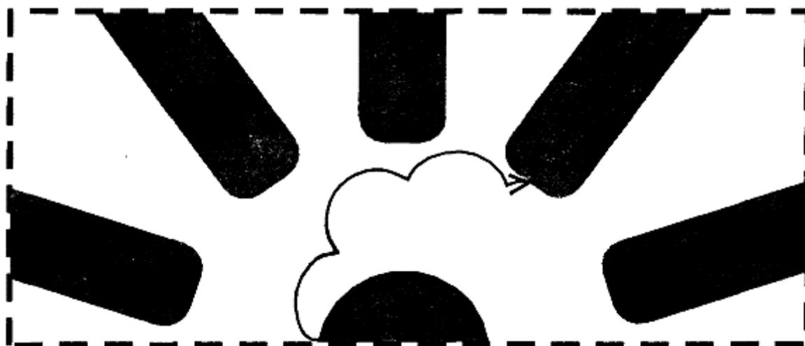
**Рис. 10** Траектория электрона, находящегося в «спице», при движении от катода к аноду
