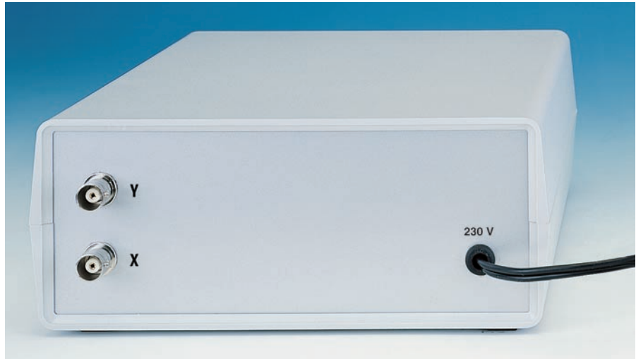
Figure 41: Photo d'un des prototypes dans son boîtier plastique. Les deux prises BNC AXE Y et AXE X, comme le montre la figure 42, vont aux entrées XY de l'oscilloscope par deux câbles coaxiaux dotés chacun de deux fiches BNC.
