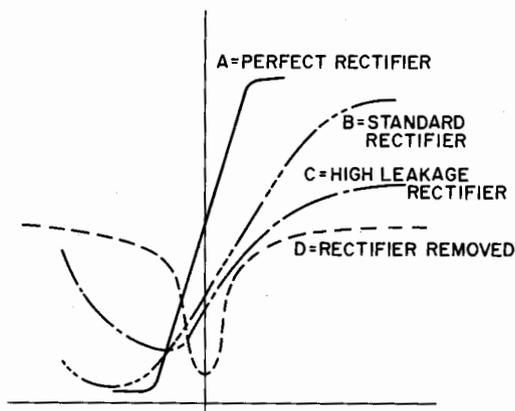
Fig. 43. Effects of rectifier leakage.
