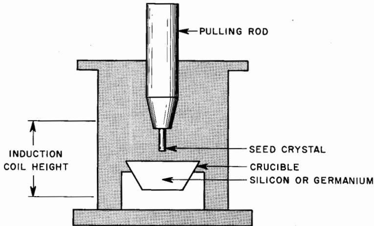
Fig. 82. Crystal-pulling apparatus.
