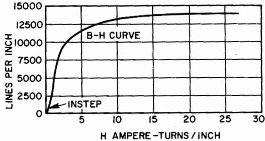
Fig. 20. B-H curve for iron.
