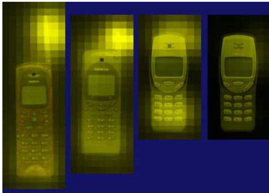
6.2. ábra: Mobiltelefonok által kibocsátott RF teljesítményeloszlás. A képekre a telefonok is arányhelyesen rá vannak montírozva. A telefonok balról jobbra: NHE5, 2110, 3210/900 MHz, 3210/1800 MHz.
