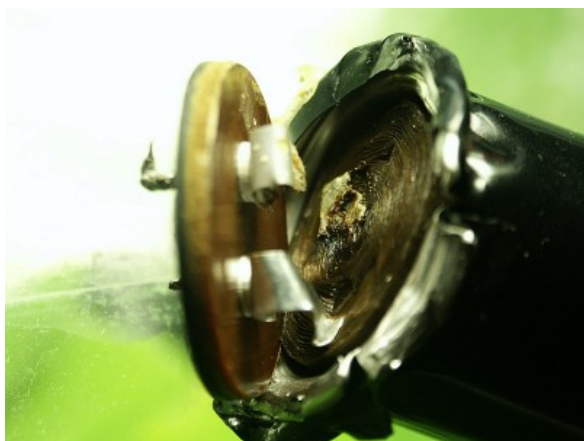
A szétszedett kondenzátorban jól látható a leszakadt láb és a hengert formáló fegyverzet alján a hozzávetésen keletkezett korrózió
