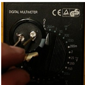
Capxon a kapacitásmérő hídon, híd kimenetén a műszer, eredmény: 0,1uF a névleges 270uF helyett
