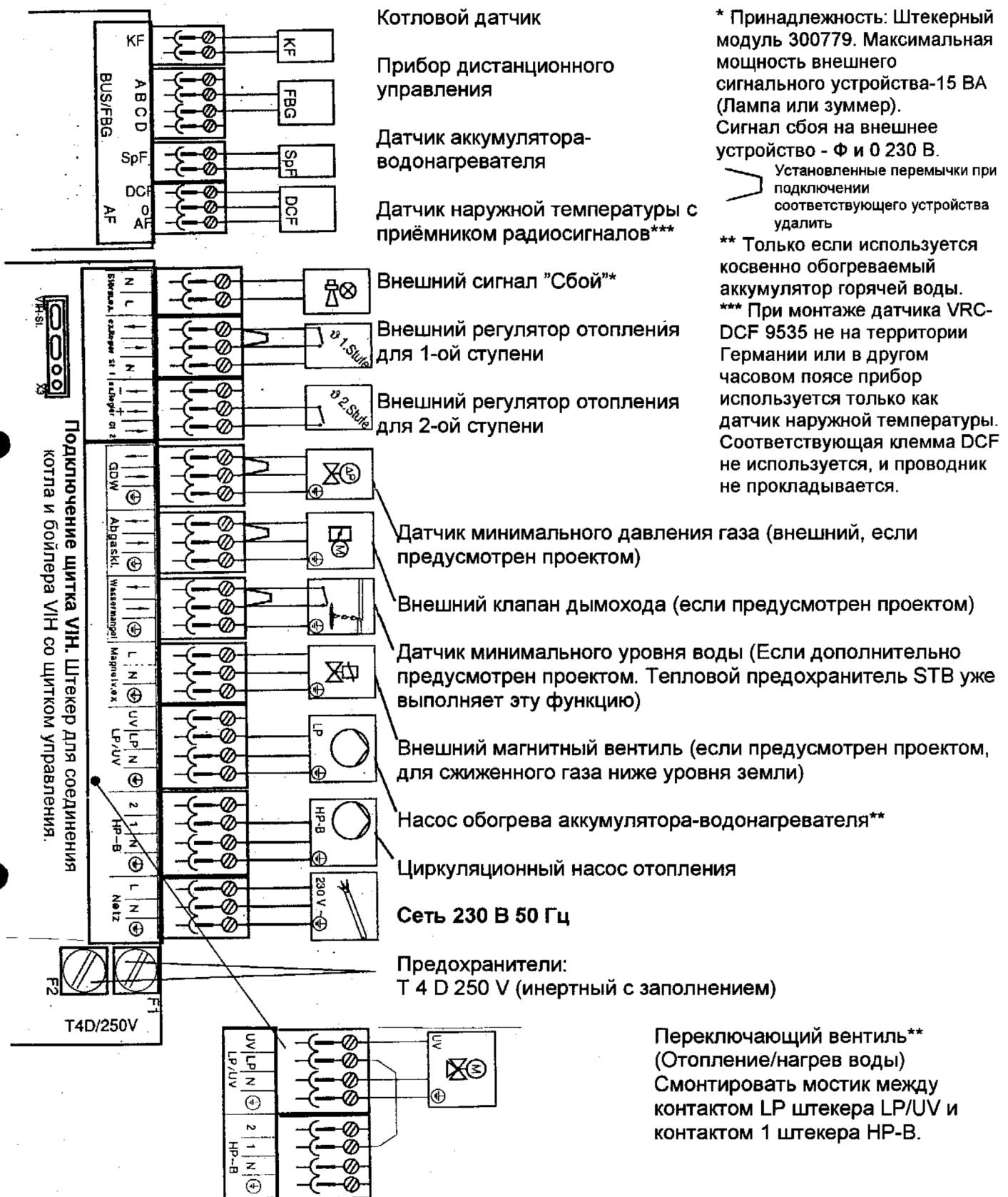
Рис. 6.3 Электрические подключения
