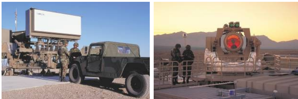
28. kép. A THEL radarja és lézertükör egysége [50]
