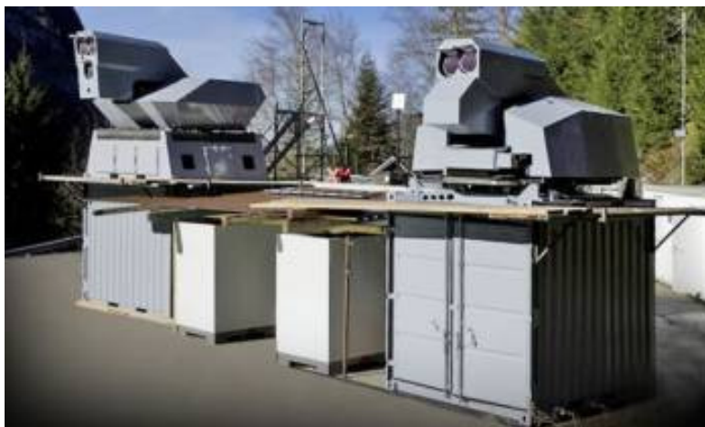
31. kép. A Rheinmetall 30 kW-os (balra) és 20 kW-os (jobbra) lézerágyúja [53]
