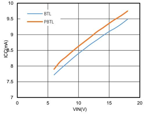
图9. 不同电源电压下静态电流
