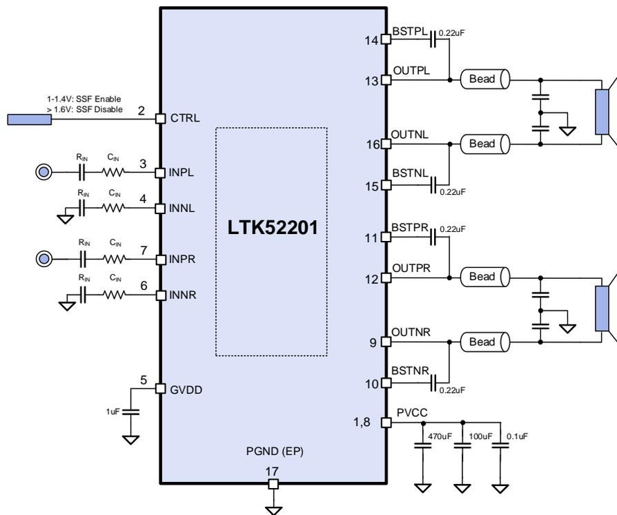
图 5. 单端输入立体声 BTL 输出模式
