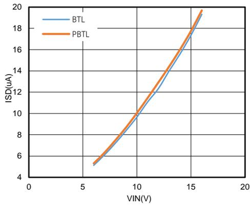
图10. 不同电源电压下关断电流
