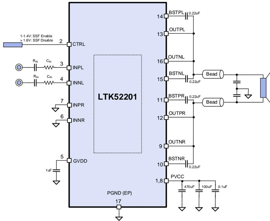
图 6. 差分输入立体声 PBTL 输出模式
