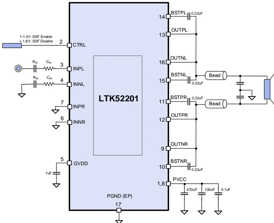
图 7. 单端输入立体声 PBTL 输出模式
