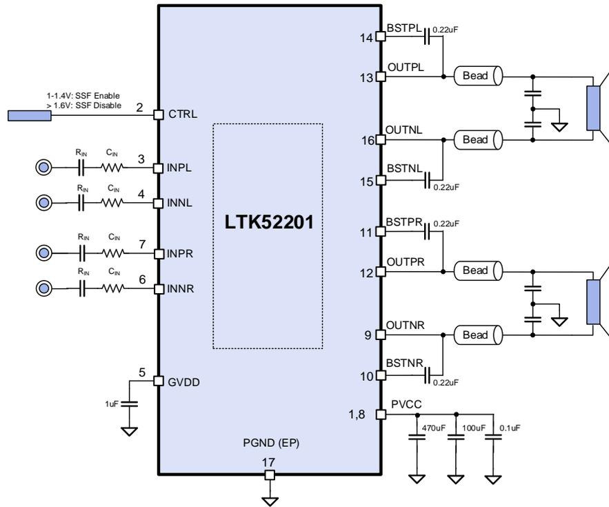
图 4. 差分输入立体声 BTL 输出模式
