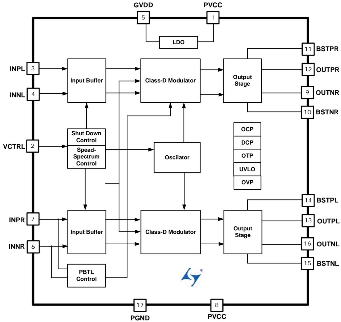
图 3. LTK52201 功能框图示意图
