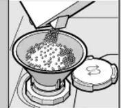
Spezialsalz einfüllen (nie Reiniger einfüllen!).
