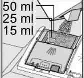
Reiniger nur in trockene Reinigerkanne einfüllen.
