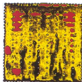
Separation von Partikeln (dunkel) Lufteneinschlüsse (rot)
