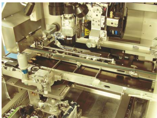
Bild 3: Das BECS (Belt Elevation Clamping System)-Verfahren richtet Chip und Träger exakt planparallel für zuverlässiges ACA-Kleben aus
