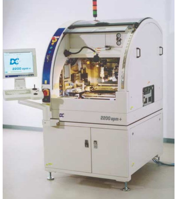
Bild 1: Modulare und flexible Geräteplattform 2200 apm+ ist mit ihrer hohen Präzision für alle Flipchip-Klebeanwendungen geeignet
