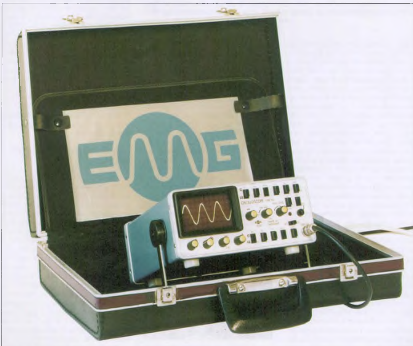
EMG Type 1554 oszcilloszkóp, tervezte Bodor Illés és Sipos Gyula 1976-ban. Formaterv: Bányai László. A készülékből egy lapostáskába éppen két darab férne be (MTI fotó)
