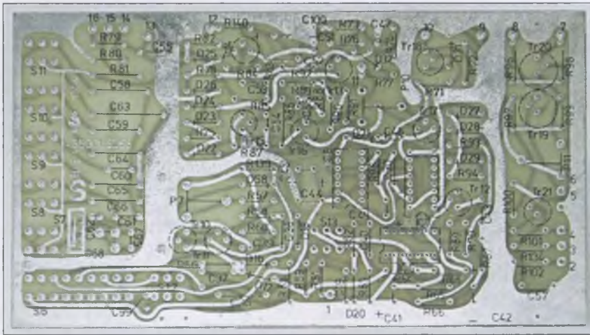
A kis szkóp „legokosabb” panelja. Balra a nyomógombos vertikális oszító, majd a meglehetősen egyszerű vertikális erősítő a szinkronjel erősítővel, jobbra az IC-s trigger- és fűrészel-fokozat, továbbá a horizontális végfokozat
